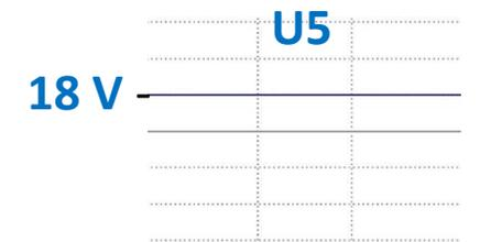
La **résistance** absorbe une partie des 21V pour que la diode Zener ait une tension abaissée à 18V à ses bornes
