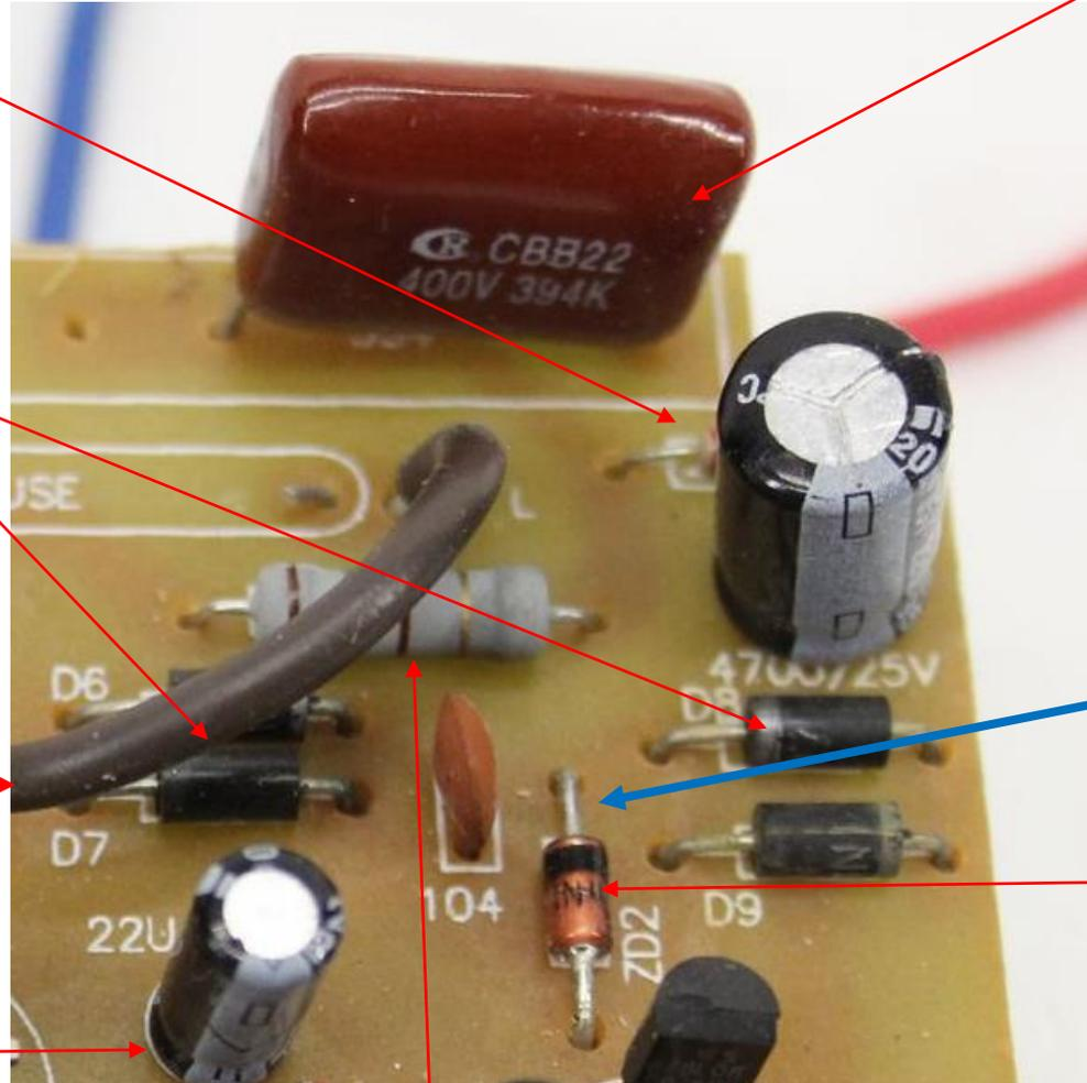
L'appareil branché, on mesure 18V continu en sortie de carte lorsqu'on alimente l'entrée en 230V alternatif.
