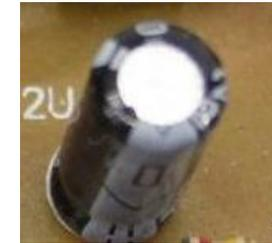
Le **condensateur** permet de lisser la tension alternative redressée par le **pont de diodes**
