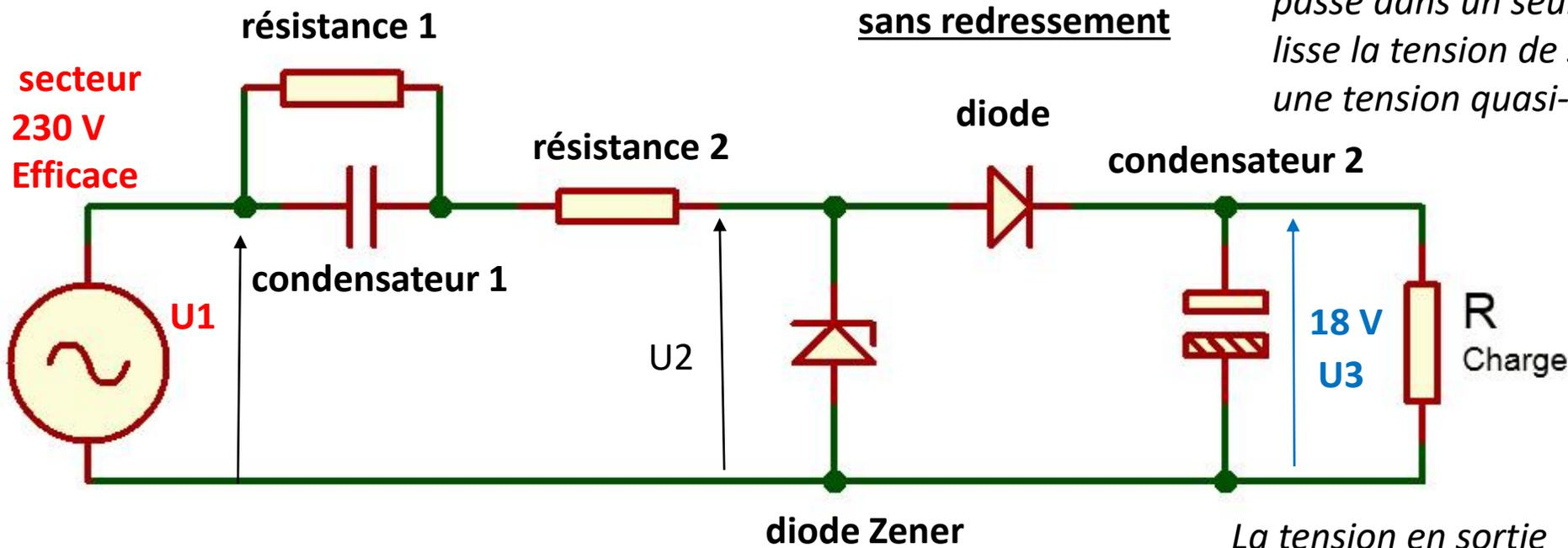
Les **diodes** laissent uniquement passer les alternances de phases positives (le courant passe dans un seul sens) et le **condensateur 2** lisse la tension de sortie. De fait, on obtient une tension quasi-stable en sortie.
